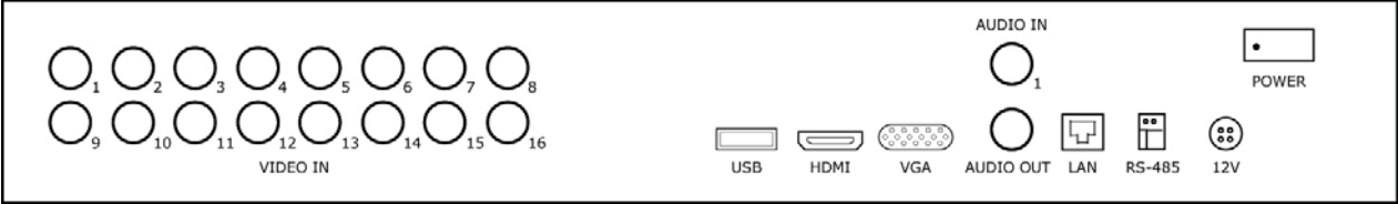
16 路 TVI Hybrid 監控錄影機後背板圖 (DS-7216HGHI-SH)
